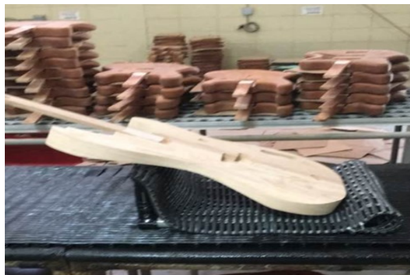
Figura 5 Aplicación de gel ultravioleta (Proceso instrumentos Musicales Fender)
