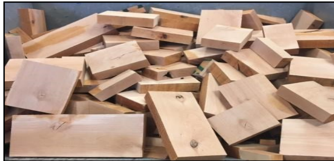
Figura 3. Tabloncillos de madera Alder para fabricar el cuerpo de una guitarra (Proceso Instrumentos musicales Fender)
