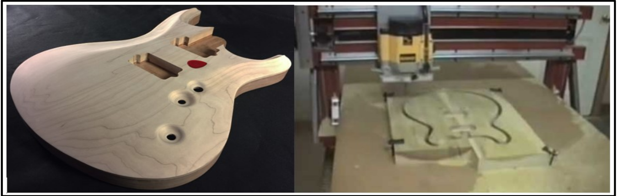
Figura 4 Cuerpo de instrumento musical a nivel Mills (proceso Instrumentos musicales Fender)
