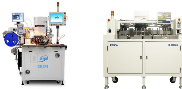
Figura 6. Tipo de Manejadoras Bowl Feeder y Pick up and Place utilizadas para el manejo de los dispositivos en el proceso de prueba.
