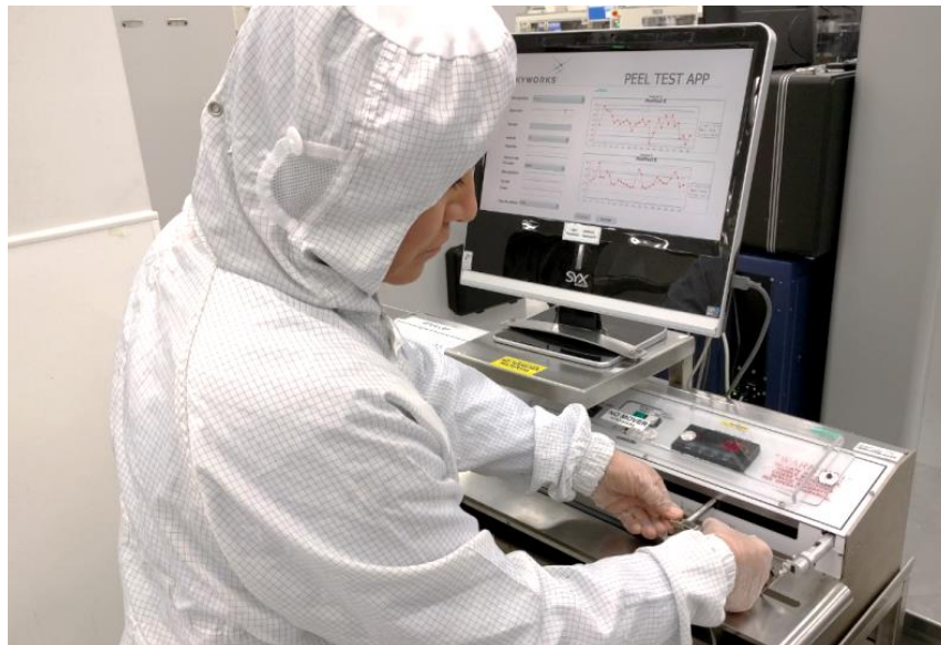
Ilustración 16 - Proceso de verificación de adherencia en rollos. Fuente: Imagen de creación propia.
