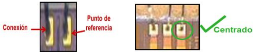
Figura 11 Defecto de fuera de offset
