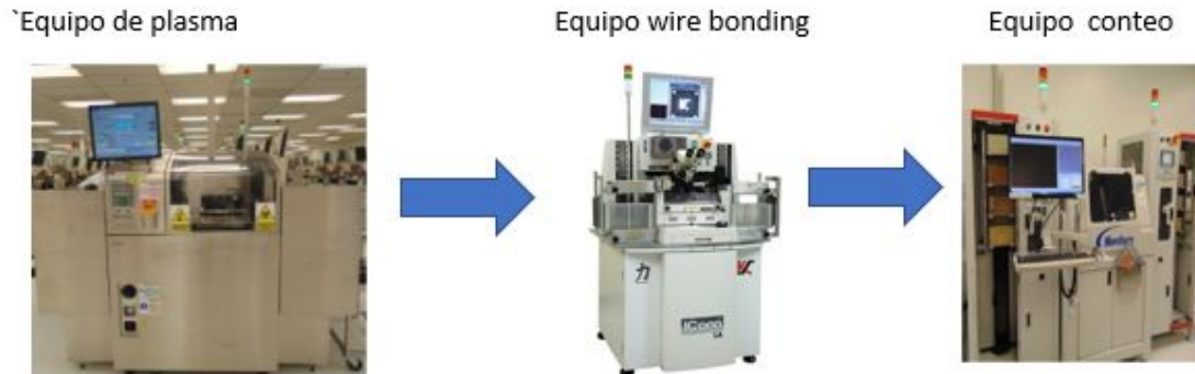
Figura 9 Flujo de proceso de wirebond
