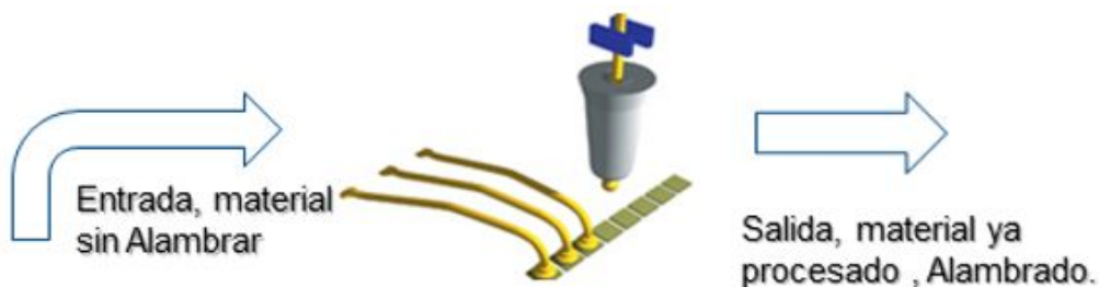
Figura 8 Proceso de wirebond
