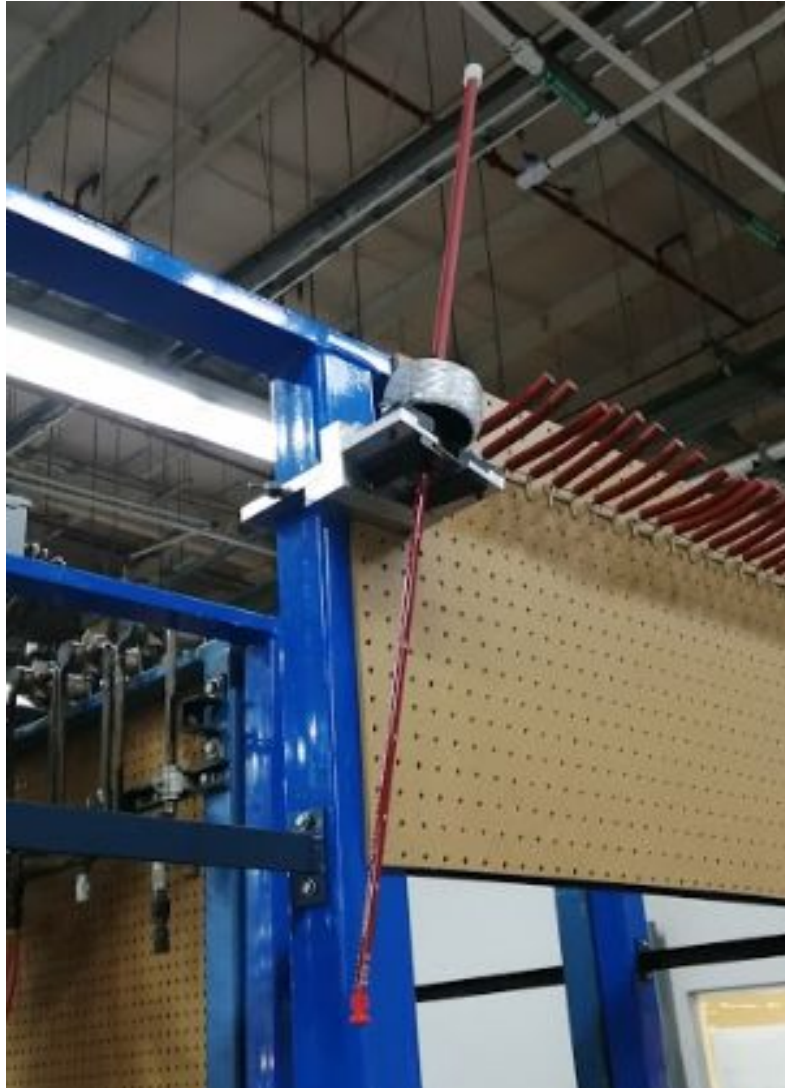
Imagen 11. Flexi liberado del tubo o housing montado en base de prueba.
