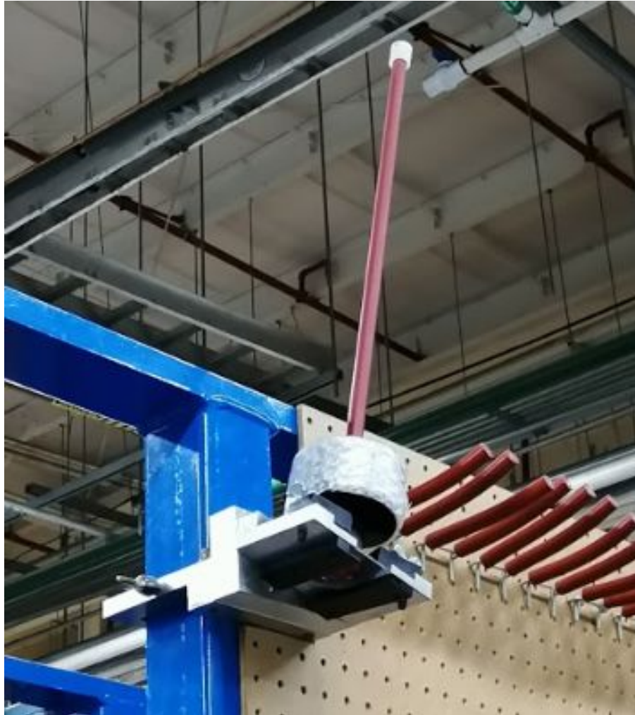
Imagen 10. Fuel Stick montado en base de prueba. Elaboración propia
