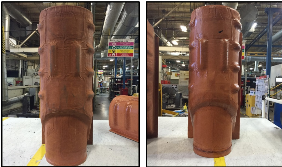
Figura 9. Izquierda. Proceso sin utilizar caul plates. Derecha. Plenum utilizando caul plates. Fuente: obtenido de documentación Honeywell.
