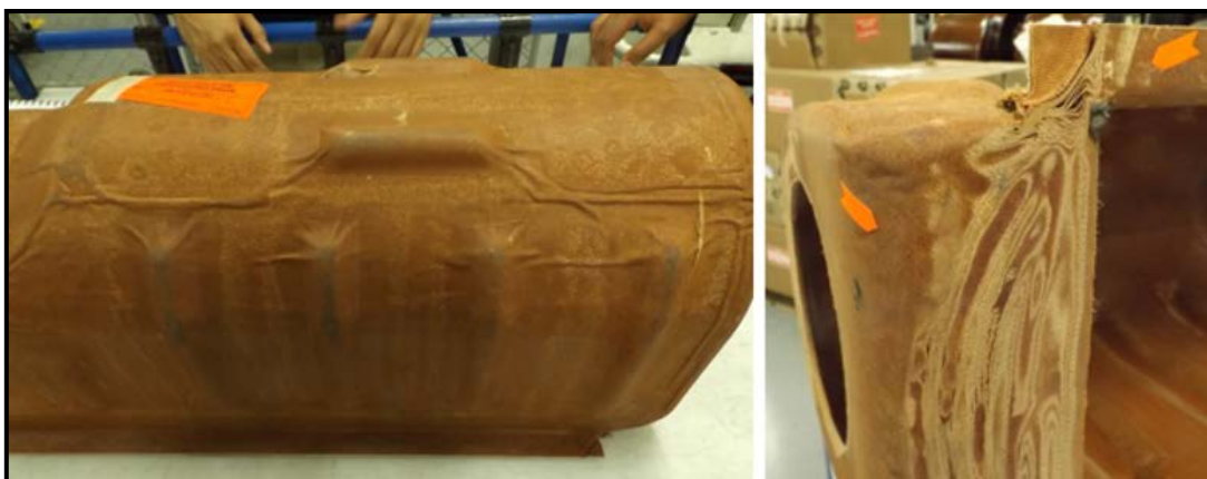
Figura 12. Defectos en Diseño actual Plenum GV. Fuente: obtenido de documentación Honeywell.
