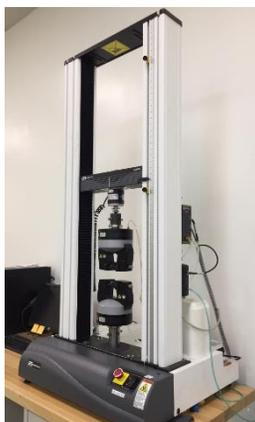
Figura 5.- Máquina Universal INSTRON 3365
