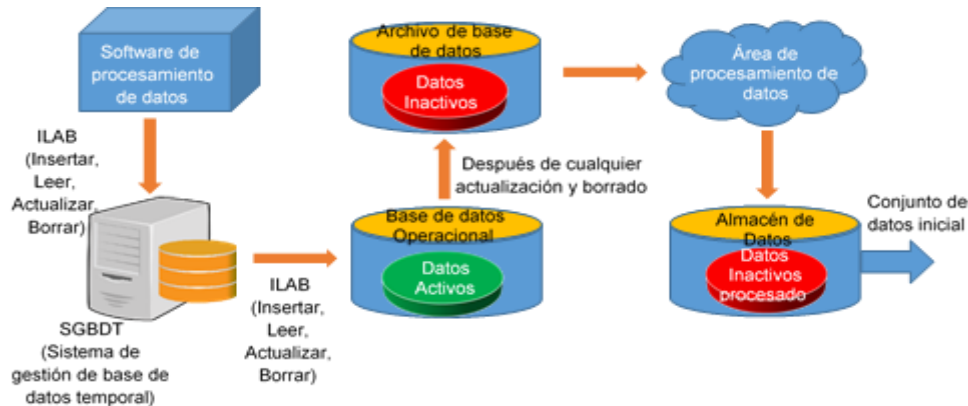
Fig. 2 Ejemplo de un sistema de administración de datos.
