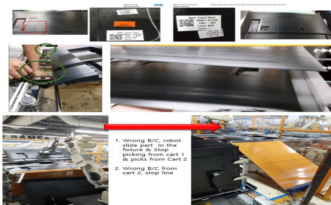
Figura 37. Sistema de escaneo a prueba de fallos para evitar tapa plástica equivocada.
