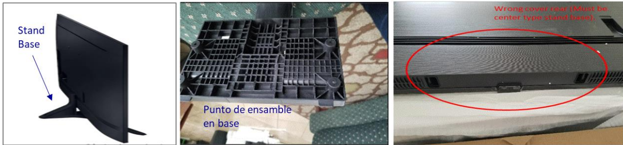
Figura 35. Problema de ensamble de base detectado con cliente.
