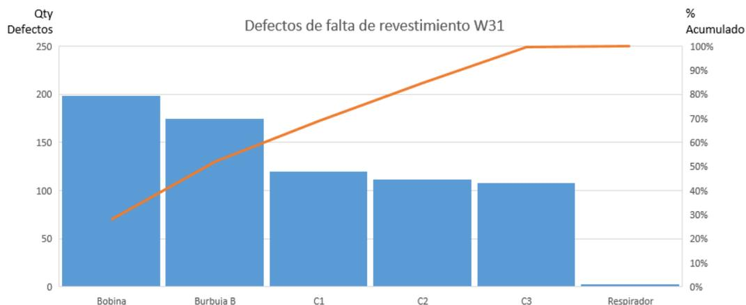
Figura 39. Histograma de defectos de falta de revestimiento W31, fuente propia.
