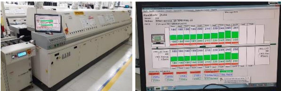
Figura 6.- Horno de reflujo y su pantalla de control. Fuente propia
