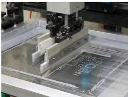
*Figura 4.- Impresión de soldadura. Fuente propia*
