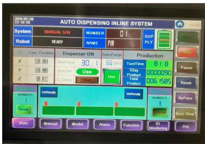
Figura 26. Pantalla de trabajo correspondiente al modelo P10. Fuente propia.
