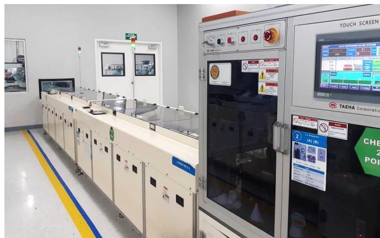
Figura 33. Conveyor de curado con acrílico. Fuente propia.
