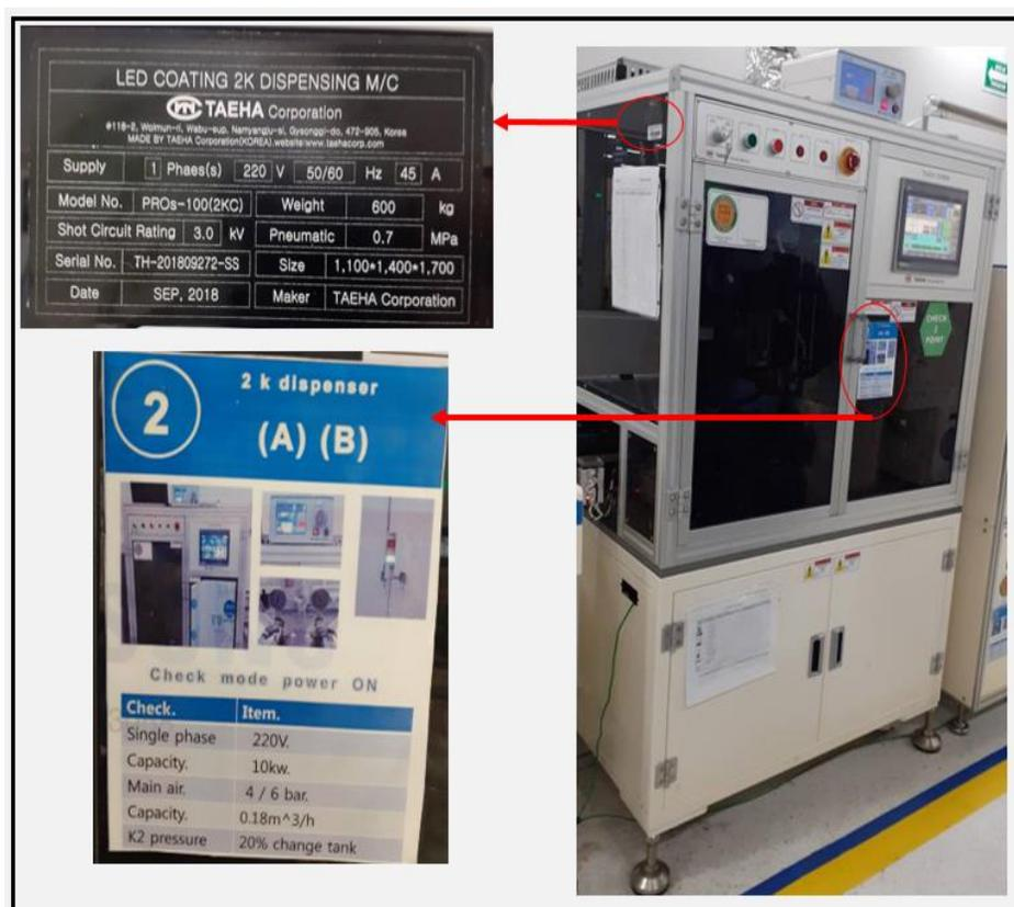
Figura 24. Máquina Led coating 2K Dispensing M/C de la Marca TAEHA. Fuente propia.
