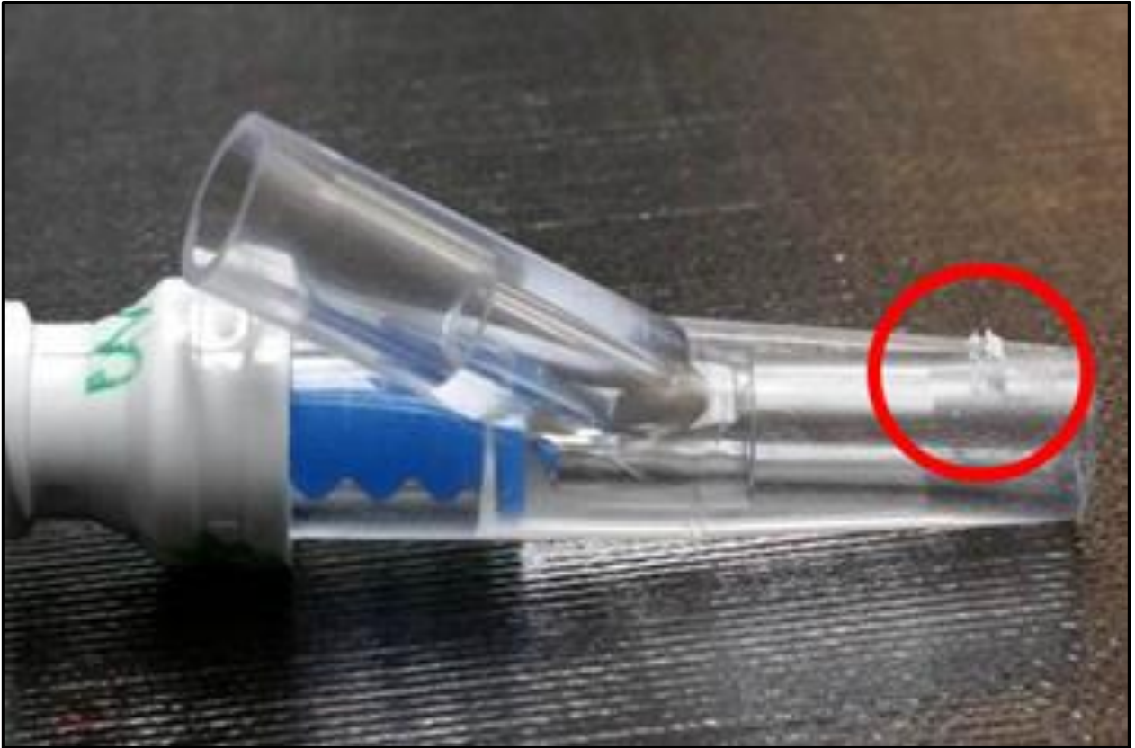
Figura 20. Condición rechazable de marcas en el cuerpo.
