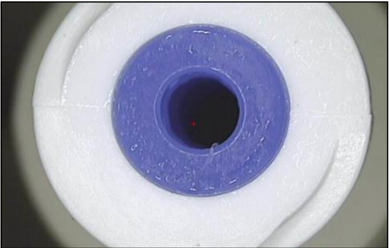
Figura 15. Condición rechazable de Pistón invertido.
