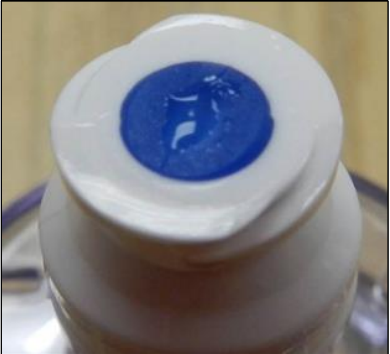
Figura 19. Condición rechazable de excedente de silicón.
