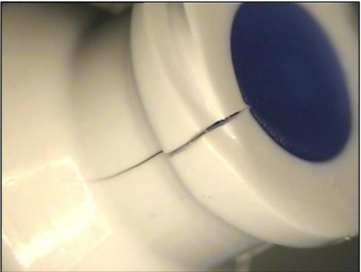
Figura 18. Condición rechazable de puerto de conexión con rosca cuarteado.
