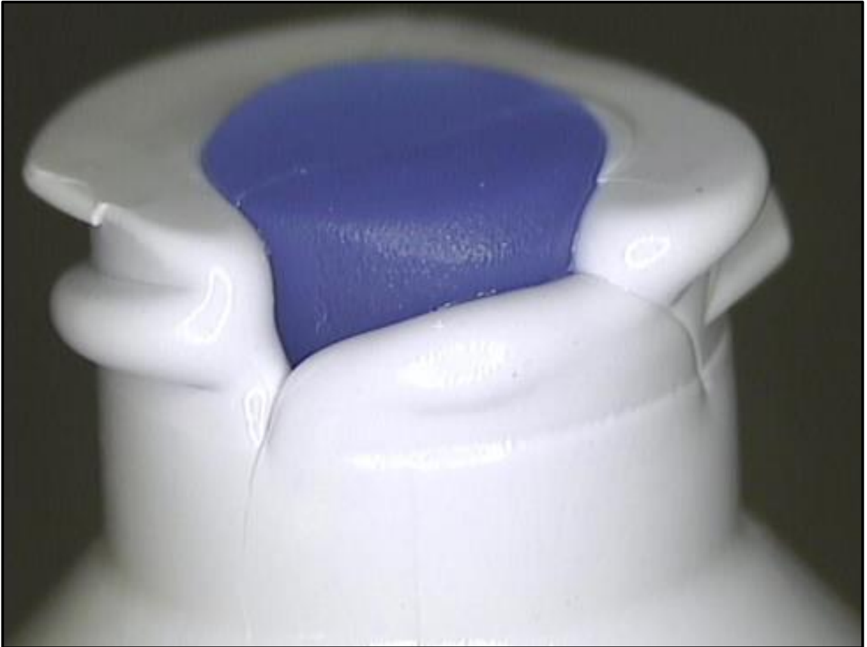
Figura 16. Condición rechazable de Inyección incompleta sobre puerto de conexión con rosca.
