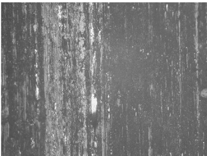
Figura 4. Partículas de transmisión de la aleación Alumelec 89. (Brezinova, 2010)
