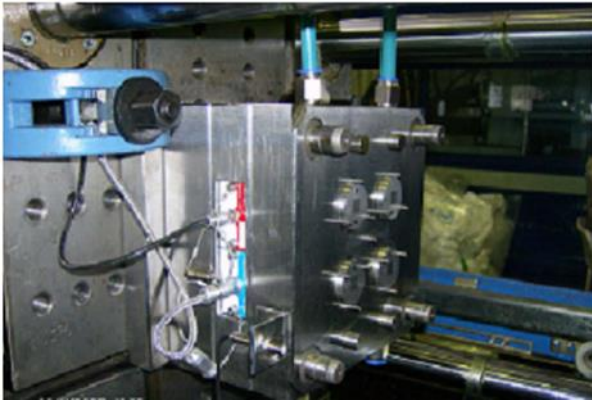
Figura 2. Ubicación de los conectores de presión y temperatura en molde. (Kurt, 2009)
