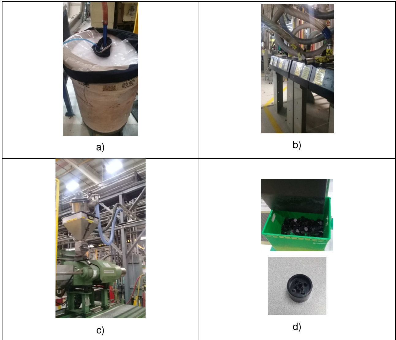
Figura 11. a) Deposito de resina al pie de la máquina (surtido manual), la identificación es hecha por el etiquetado del proveedor. b) Tubería de llegada de los silos a los acumuladores y secadores (surtido automatizado), de ahí son tomadas muestras para verificar la resina sea la correcta. De este lugar es surtida a las máquinas de inyeccion por medio de tuberias. c) Entrega de material a la máquina de inyeccion, aqui no hay forma de muestrear el material por la automatización del proceso. d) Piezas terminadas, muestras para el proceso de QA son tomadas, en esta etapa pueden detectarse problemas de resinas por los efectos secundarios en la calidad de las piezas.
