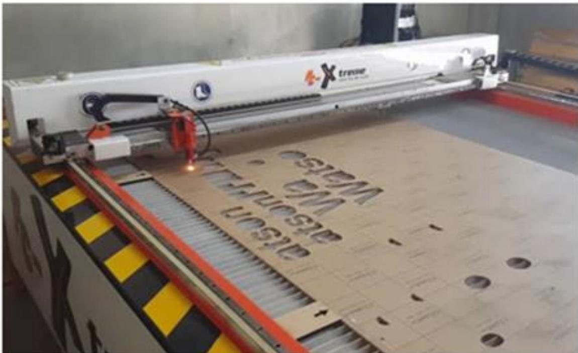
Figura 7. “Máquina CNC de Corte Láser”. Fuente:(Marín, 2016).
