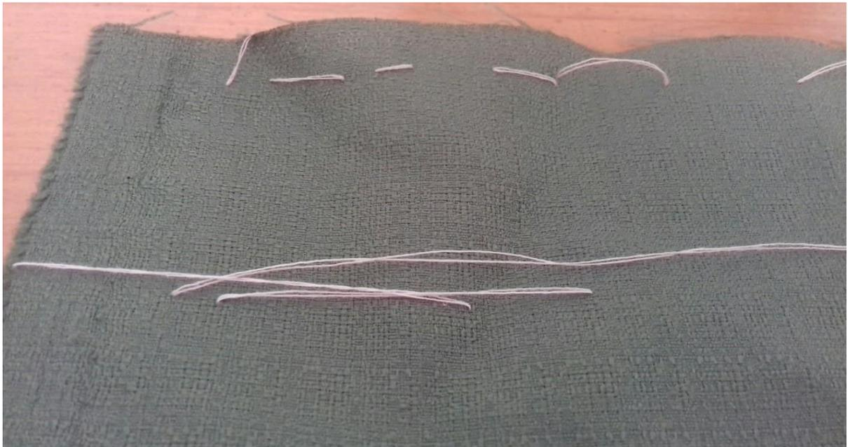
*Figura 14. "Patrón de costura lineal generado por cabezote electrónico parte posterior". Fuente: (Elaboración propia).*
