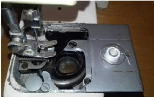
**Imagen4:** "Porta Bobina y Bobina separados"
