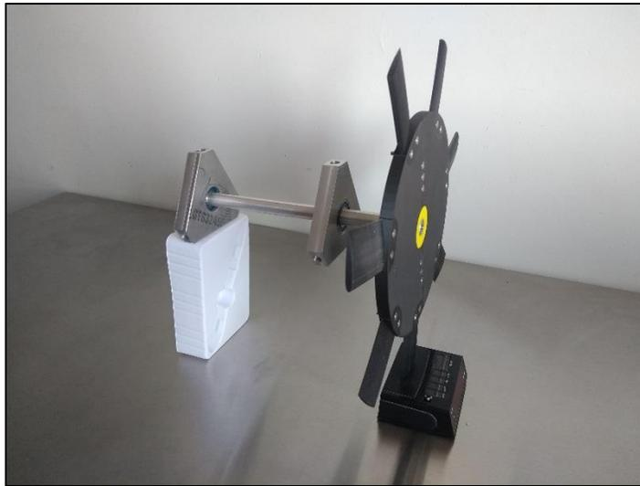
**Figura 26. Ensamble físico de cuerpo de turbina con el soporte de la turbina.**
