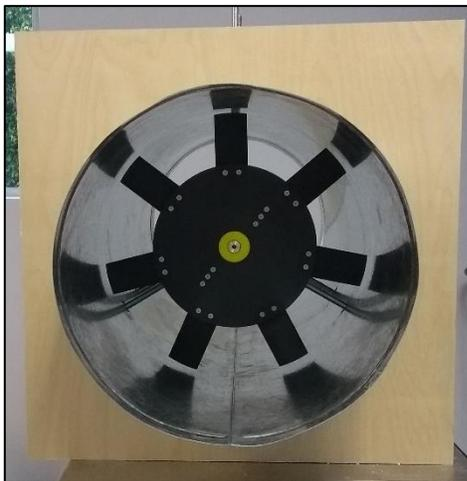
**Figura 28. Turbina Wells 1:6.667 instalada en el túnel de viento para medición de parámetros.**
