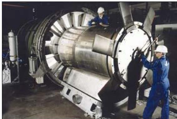
**Figura 12. Turbina Wells utilizada en el sistema LIMPET 500. [Recuperada de: <https://www.carbontrust.com/media/173555/owc-report.pdf>]**
