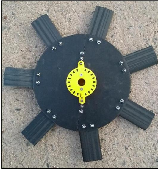
**Figura 25. Sub-ensamble del cuerpo de la turbina junto con álabes.**
