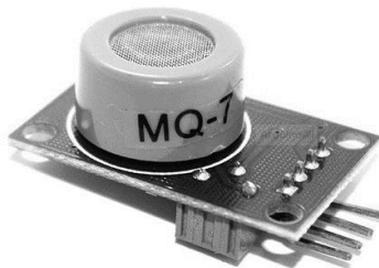
Figura 6 Sensor tipo semiconductor (VegaROBOKit,2019)
