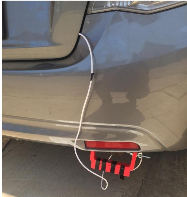
Figura 22 Montaje del sensor de CO en automóvil
