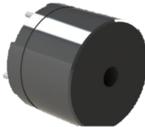
Figura 15 Buzzer 5v, utilizado para registrar cuando el CO disminuía o aumentaba
