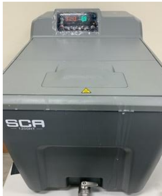
Figura 60 Tina para remover soportes (SCA-1200HT)
