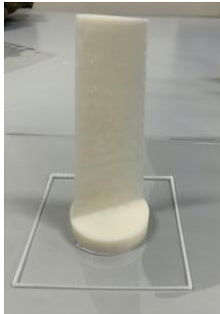
Figura 80 Ábabe antes de remover soportes
