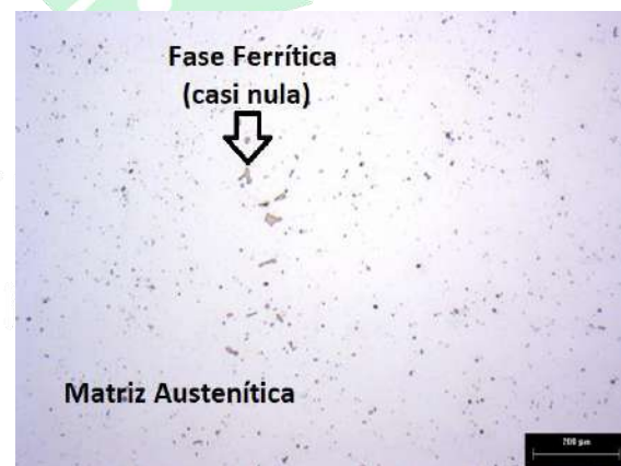
Figura 4. Micrografía de Acero Propuesto con menor contenido de Fase Ferrita.
