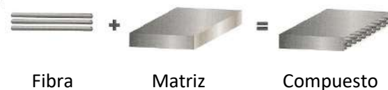
Figura 1. Componentes de un material compuesto [2]
