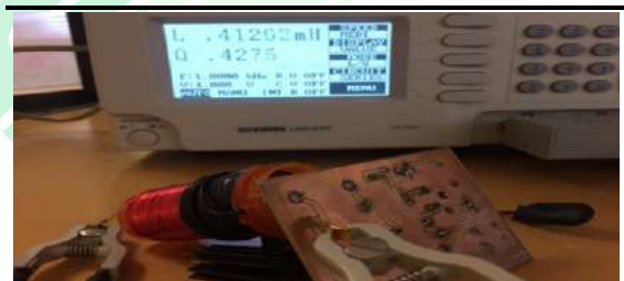
Figura 3.6. Inductancia de la bobina secundaria.
