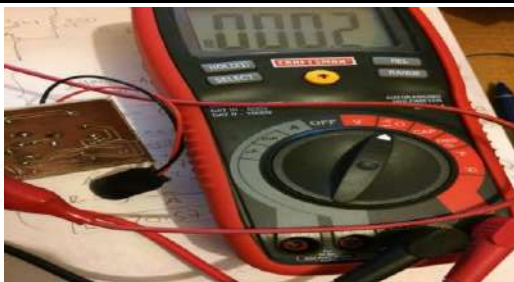
Figura 3.2. Medición de la resistencia de la bobina primaria
