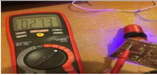
Figura 3.4. Medición de la capacitancia parasita.
