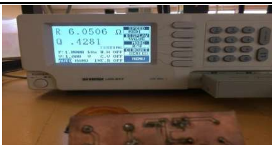
Figura 3.5. Medición de la resistencia de la bobina secundaria.
