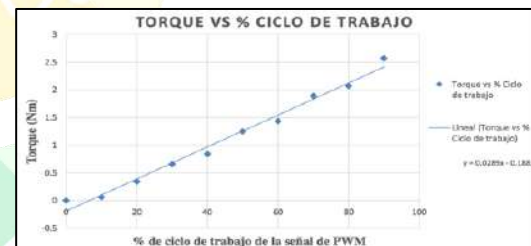
Figura 7. Grafica de resultados del tercer motor, se puede observar la inercialidad del motor.
