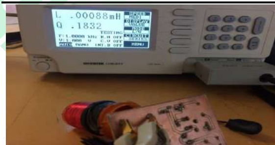
Figura 3.3. Medición de la inductancia de la bobina primaria.
