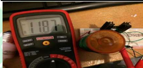
Figura 3.8. Medición del voltaje del transistor
